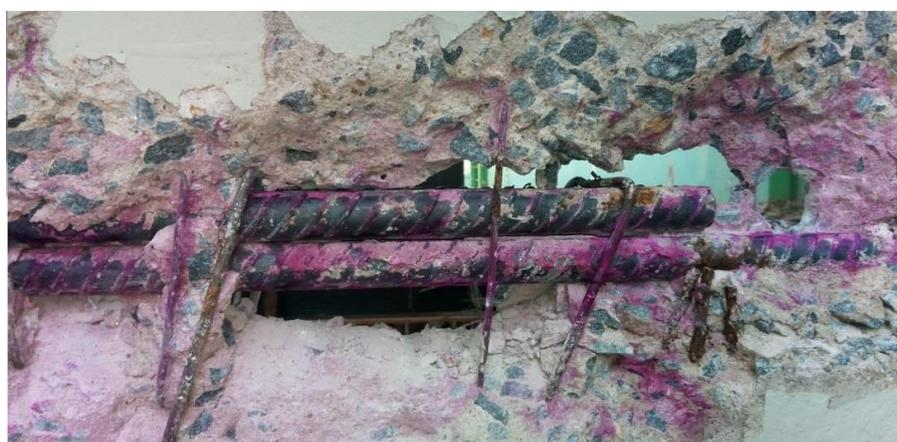
Figura 8 - Teste de carbonatação – Ponto C4
