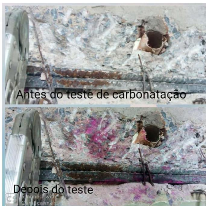
Figura 9 - Teste de carbonatação – Ponto C4
